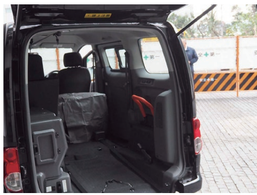
にっさんえぬびにひやく くるまいすしやう 日産NV200タクシー(車椅子仕様) は車体後部からスロープと電動ウインチ で正面から楽に乗ることが出来る。
